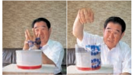
サニーレタスの包装道具箱の上に出た筒状のところはストッキング素材の布がかぶせて滑りがよくしてある。ここに包装紙を裏返しにのせて、葉の部分が広がったサニーレタスの上の部分に合わせて滑らすと葉の部分だけの包装が簡単にできる。いまや日本中で使われている便利な道具である。使い方を身振り手振りでも説明してくれた朝倉さん。
