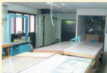
↑荷造り出荷場のレイアウト。手前：切り花の調製束づくり台、右奥：鮮度保持剤前処理・荷造り室、左奥扉：調製用冷蔵庫、左手前：梱包機。
