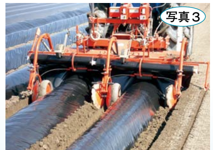
↑ 0.02mm厚と薄手のハイバリアーで機械展張とマルチ畝内処理が可能に！
