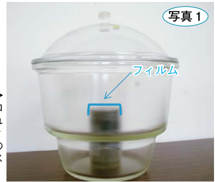
→ ビンの内部にクロルピクリンを入れた缶を置き、フィルムで覆う。缶の外に漏れ出たガスの濃度を測定。
