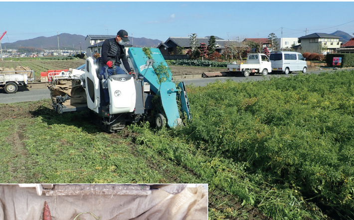
↑「京くれないEX」の圃場。条間18cm株間6cm、収穫はほとんど機械でされる。収穫と同時に葉の部分がカットされ、袋の中へ。
