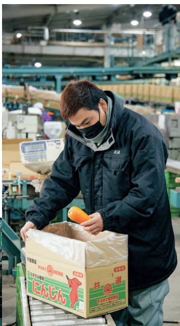
↑←2度の水洗いで磨かれ、センサーでの選別と人間のチェック、手作業を経て大事に箱詰めされていく。
