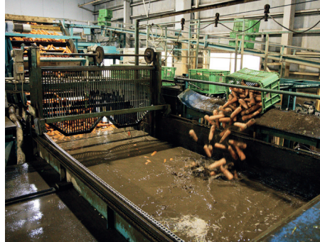
↑先ずはプールで泥が落とされる。水に浮いたニンジンはこの時点で除かれる。
