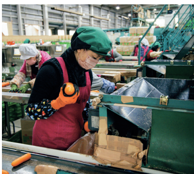
↑←2度の水洗いで磨かれ、センサーでの選別と人間のチェック、手作業を経て大事に箱詰めされていく。
