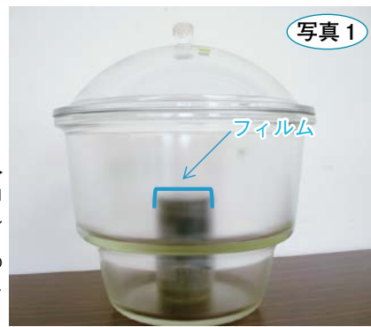
→ ビンの内部にクロルピクリンを入れた缶を置き、フィルムで覆う。缶の外に漏れ出たガスの濃度を測定。
